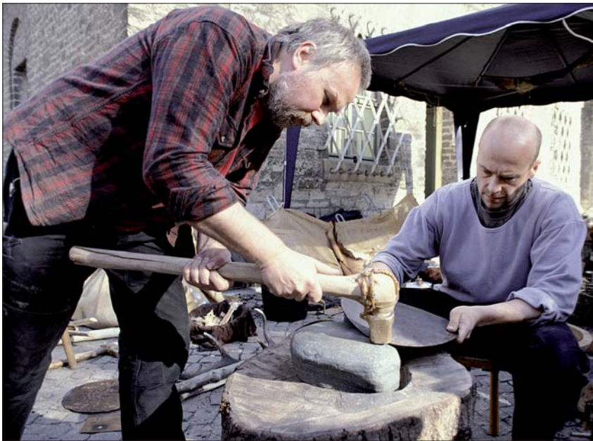
Abb. 8 Dehnen und Strecken der Rohform durch Ausschmieden mit einem Bronzehammer auf einem Steinamboss.
