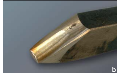
Abb. 13 Einarbeiten der Goldauflage mit einem stumpfen Bronzestichel.
