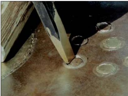
Abb. 14 Brechen der Kante der inneren Konturlinie mit einer Bronzezunze.
