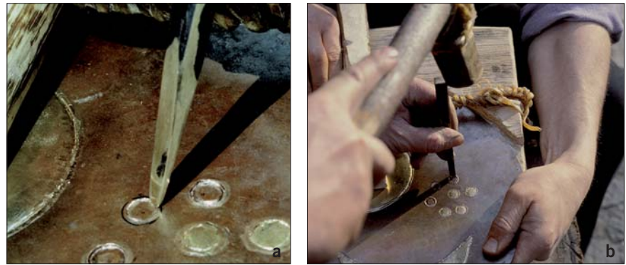
Abb. 11 Anreißen der Konturlinie für eine Goldauflage. a Anreißen mit einem Bronze-meißel; b Praktische Umsetzung durch zwei Personen.
