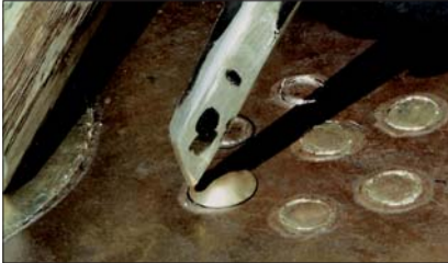
Abb. 13 Einarbeiten der Goldauflage mit einem stumpfen Bronzestichel.
