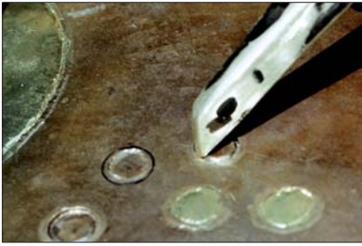
Abb. 12 Unterschneiden der Oberfläche mit einem Bronzestichel.
