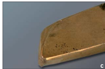
Abb. 14 Brechen der Kante der inneren Konturlinie mit einer Bronzezunze.
