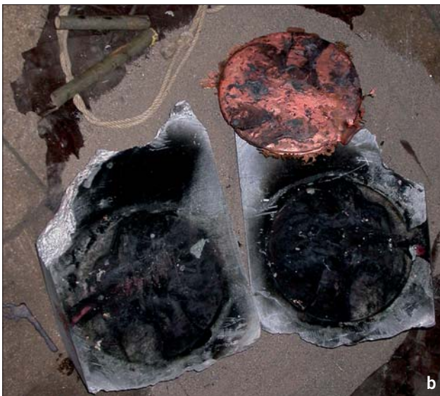
Abb. 3 a Guss eines Scheibenrohlings in eine aufrecht stehende Kokillenform (Speckstein) bei etwa 1200° C; b Offene Form mit Scheibenrohling.
