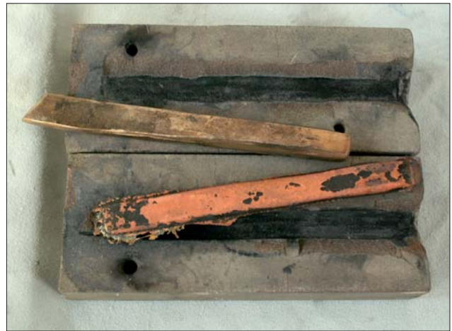
Abb. 7 Von den Verfassern gefertigte Punzen. Gussrohling und fertig überarbeitetes Stück auf der zugehörigen Sandsteinform.
