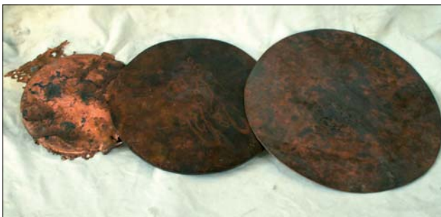
Abb. 9 Verschiedene Fertigungsstadien des Scheibenrohlings.
