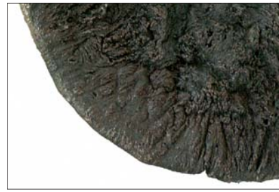
Abb. 4 Oberflächen-detail eines im offenen Herdguss gefertigten Gusskuchens.
