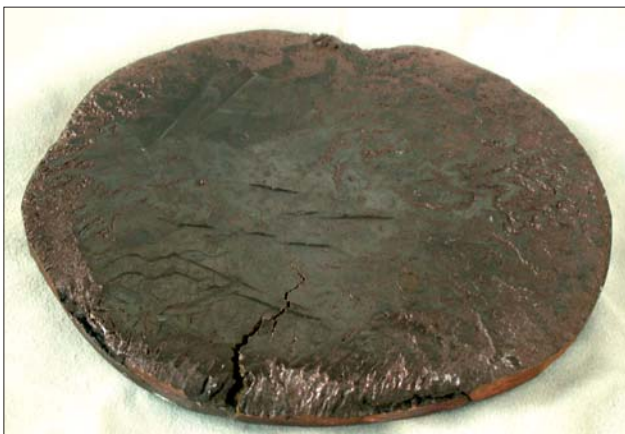
Abb. 10 Fertigungsfehler bei einer Scheibe, die aus einem im offenen Herdguss hergestellten Gusskuchen gefertigt worden und in einem frühen Stadium des Ausschmiedens randlich eingerissen ist.
